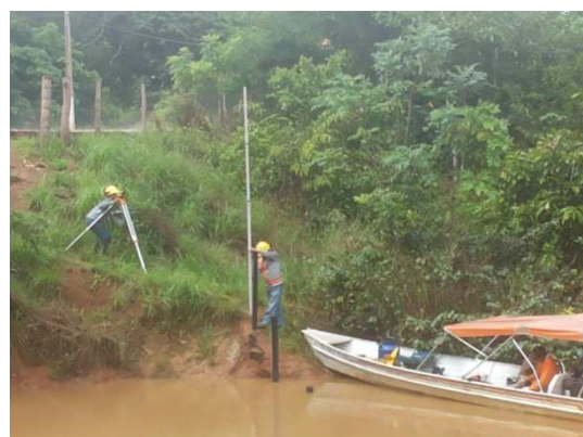
Figura 6: Alinhamento da Régua para medição de Nível do Igarapé Panelas.
