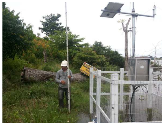
Figura 8: Continuação da atividade de alinhamento da régua da Estação Mangueiras.
