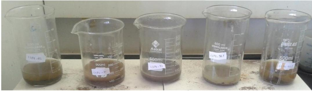
**Figura 9.3 - 6 - Amostras de rocha em ataque de peróxido de hidrogênio. Laboratório TERRAGRAPH, Brasília-DF.**
