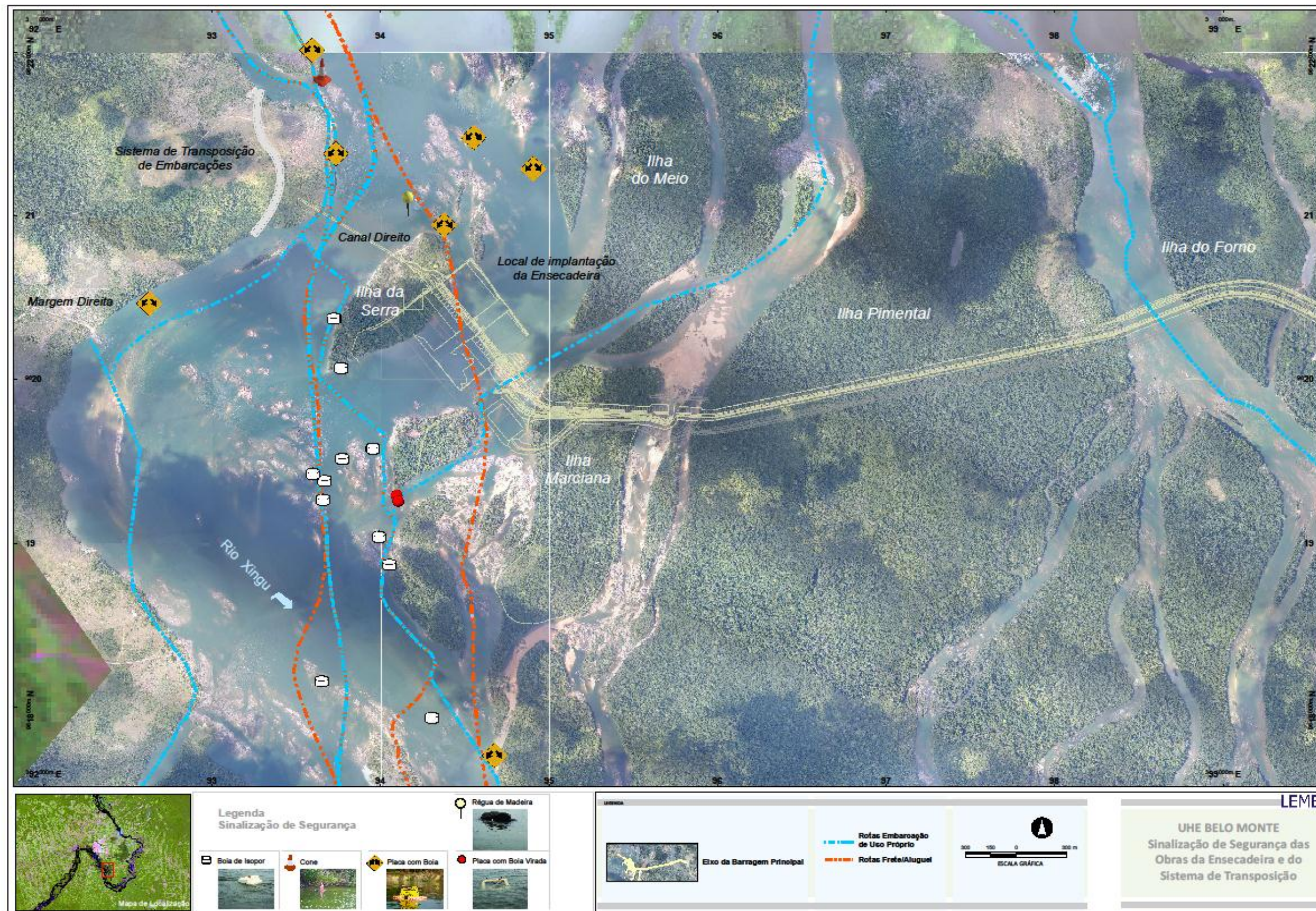
Figura 14.2.4 – 3 - Situação atual da sinalização náutica nos trechos fluviais próximos ao Sítio Pimental Fonte: Pesquisas LEME Engenharia 2012
