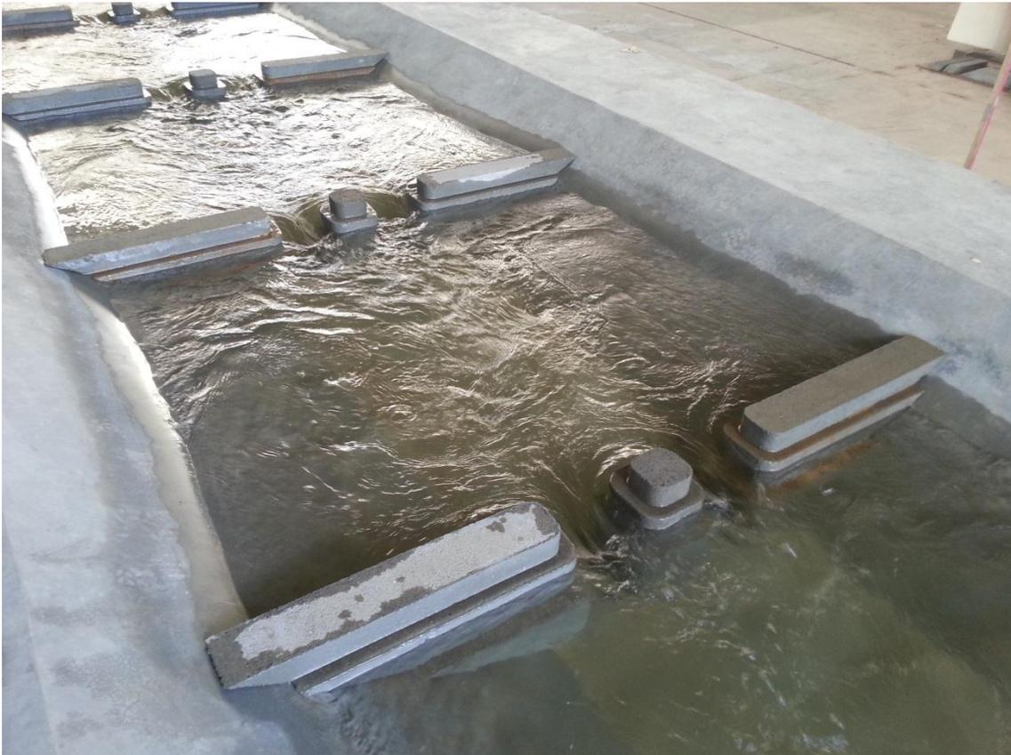
**Figura 13.3.6 – 10 - Escoamento para a Geometria Adotada**
