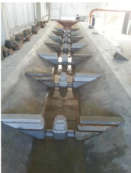
**Figura 13.3.6 – 8 - Escoamento para a Geometria Otimizada (com soleiras)**
