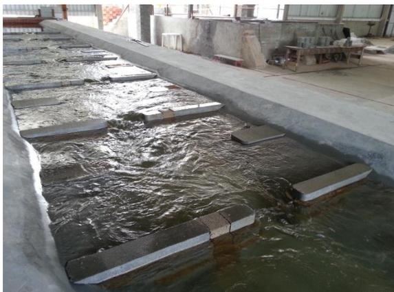
**Figura 13.3.6 – 6 - Escoamento para a Geometria Inicial Modificada**
