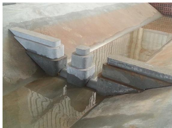
**Figura 13.3.6 – 9 - Escoamento para a Geometria Otimizada (com soleiras)**
