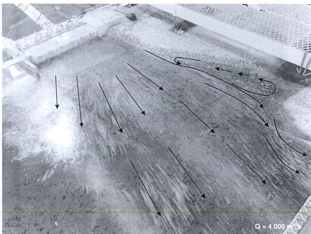
Figura 10 – Alternativa Final – Q = 4.000 m 3 /s – Configuração do escoamento a jusante da Casa de Força Complementar
