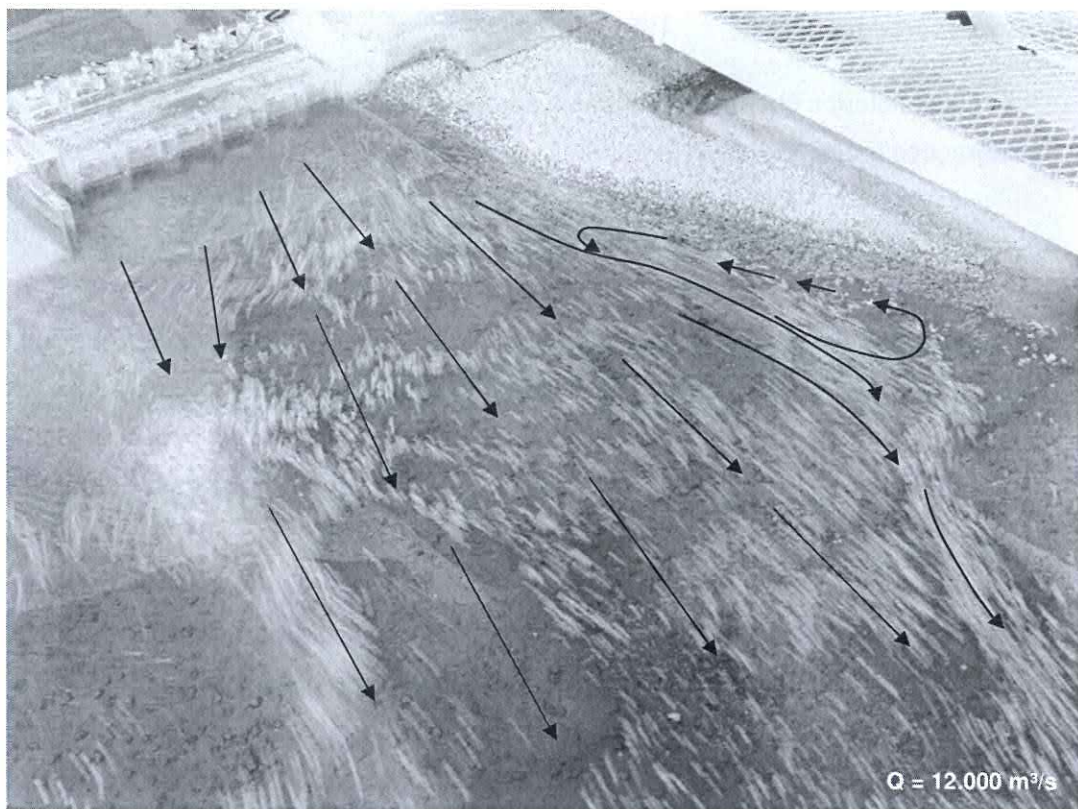
Figura 12 – Alternativa Final – Q = 12.000 \text{ m}^3/\text{s} – Configuração do escoamento a jusante da Casa de Força Complementar
