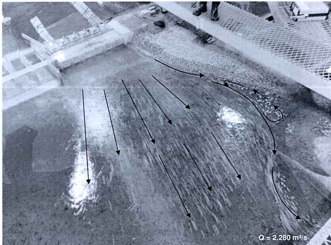
Figura 9 – Alternativa Final – Q = 2.280 \text{ m}^3/\text{s} – Configuração do escoamento a jusante da Casa de Força Complementar
