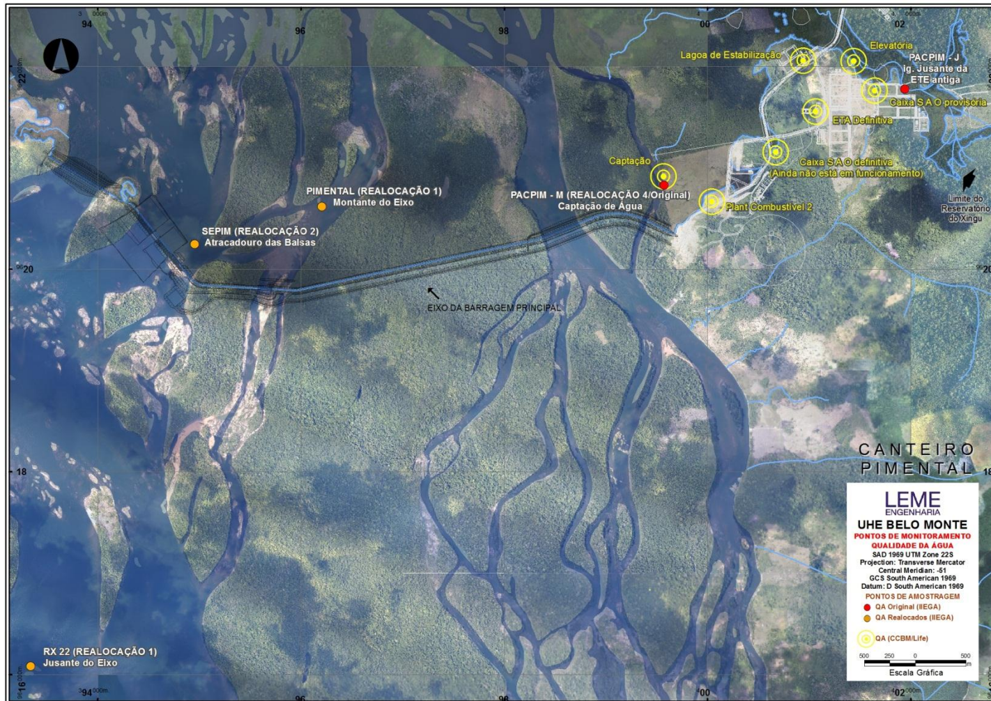
Figura 11.4.1 - 26: Localização dos pontos de coleta da qualidade de água no entorno dos canteiros e os pontos de lançamento de efluentes industriais e sanitários, lagoa de estabilização, pontos de captação de água e ETA no Canteiro Pimental, UHE Belo Monte.
