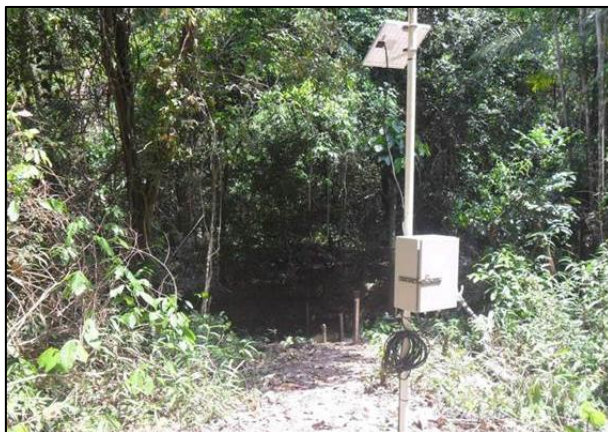
11.2 - 1 - Estação Fluviométrica do Igarapé Cajueiro- Observar a instalação das Réguas, do limnógrafo e da PCD.
