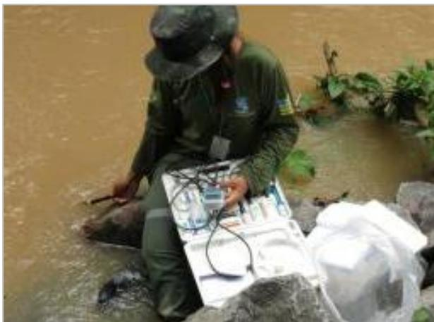
**Foto 27.** Análise química da água dos pontos de coleta, através de kit multi-analisador.
