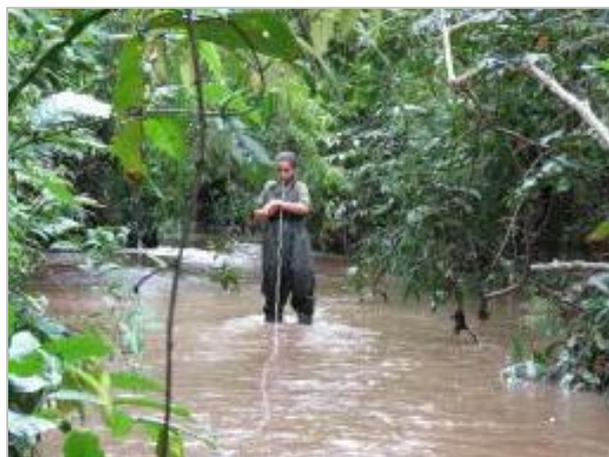
**Foto 30.** Mensuração da velocidade da correnteza, com auxílio de um flutuador acoplado a corda milimetrada.
