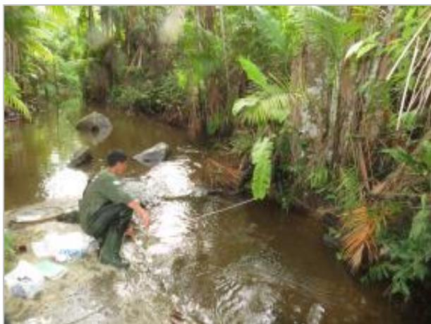
**Foto 31.** Medição da largura média dos trechos amostrados, com auxílio de fita métrica.
