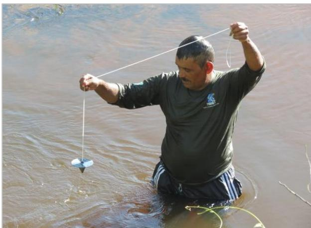
**Foto 29.** Análise da transparência da água, com auxílio do disco de Secchi.
