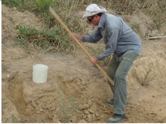
Figura 10.3-3 – Escavação do núcleo do bloco do qual será retirada a amostra indeformada
