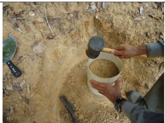
Figura 10.3-8 – Uso de marreta de borracha em golpes leves para facilitar o encaixe da amostra sem deixar espaços entre a amostra e a porção
