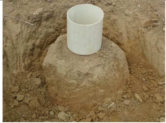
Figura 10.3-4 – Ilustração do bloco indeformado já separado da matriz do perfil de solo de onde a amostra será retirada
