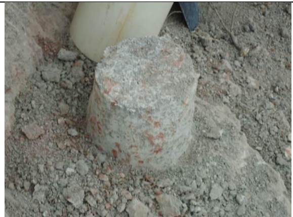
Figura 10.3-4 – Ilustração do bloco indeformado já separado da matriz do perfil de solo de onde a amostra será retirada
