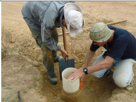
Figura 10.3-5 – Processo de lapidação do bloco utilizando o tubo de PVC como gabarito. Esta etapa deve ser feita com auxílio de pá reta, espátula e facão
