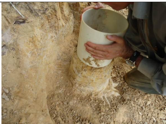
Figura 10.3-7 – Processo de encaixe do tubo de PVC
