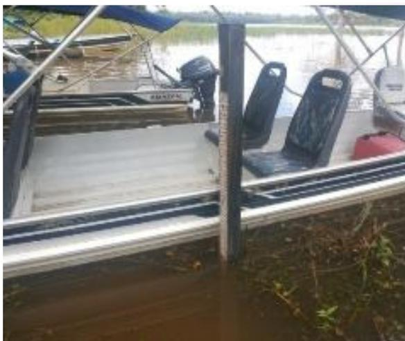
Figura 87: Régua de medição de nível da Aldeia Paquiçamba.
