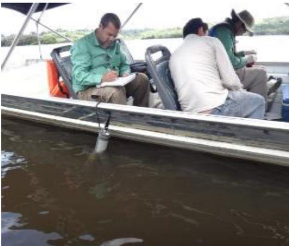
Figura 66: Sonda que determina em tempo real: PH, Condutividade Elétrica, Turbidez, Oxigênio dissolvido, Temperatura da água e os Sólidos Dissolvidos totais.
