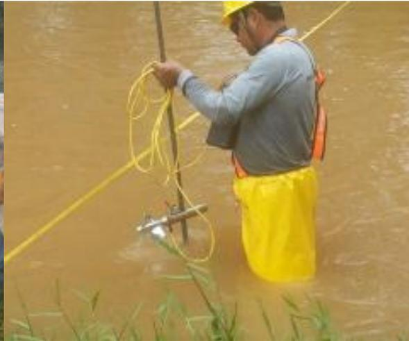
Figura 73: Molinete utilizado para medição da velocidade em corpos d'água de baixa vazão.
