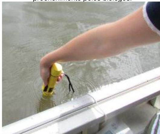
Figura 36: Profundímetro – aparelho utilizado para medir a profundidade do local.
