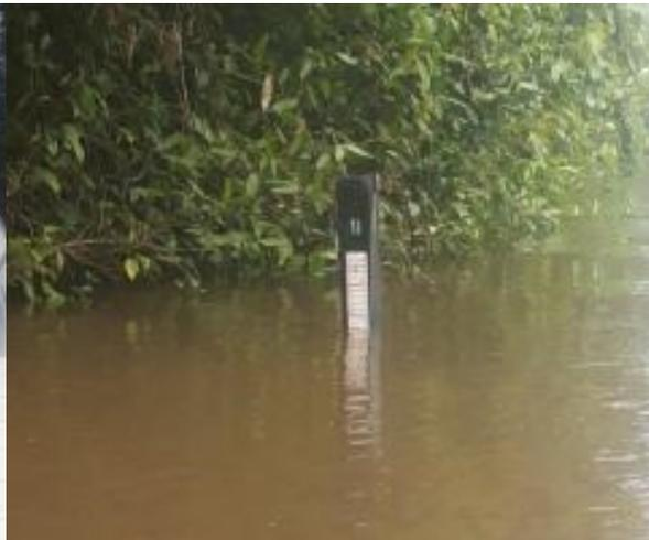
*Figura 86: Régua de medição de nível da Estação Foz do Bacajá.*
