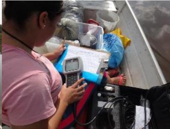
Figura 24: Sonda utilizada para medir a temperatura, condutividade e oxigênio da água.
