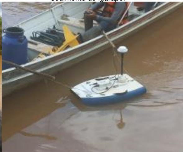
Figura 77: Medição da vazão do Igarapé Panelas sendo utilizada por meio do Medidor Acústico de Efeito Doppler – ADCP.
