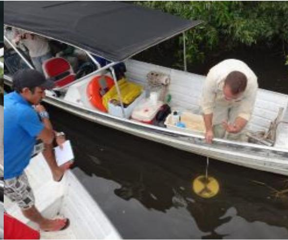
Figura 63: Medição da transparência da água com o Disco de Secchi.
