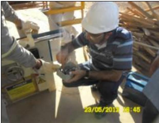
**Figura 3.4.1 - 18 - Inovações de bloqueio para operação segura de máquinas – NR 12**
