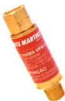
Utilizada para evitar o retorno da chama que, eventualmente, pode ser acompanhado por uma onda explosiva. Quando a chama queimar dentro da extensão e caracterizar um retrocesso, deve-se fechar imediatamente a válvula de oxigênio do maçarico, para interrompê-lo, em seguida, fechar a válvula de acetileno e deixar resfriar o maçarico.
