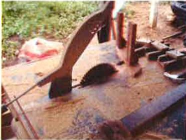
Lâmina separadora ou cutelo divisor é um dispositivo que se instala atrás da lâmina da serra, cuja função é manter separadas as partes já serradas da madeira, evitando que se encostem, aprisionando o disco, o que pode causar o retrocesso do material.
