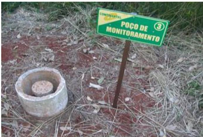
Equipamentos para o acompanhamento e controle ambiental do empreendimento, como poços de monitoramento de águas subterrâneas, medidores de vazão, piezômetros e medidores de recalque horizontais e verticais.
