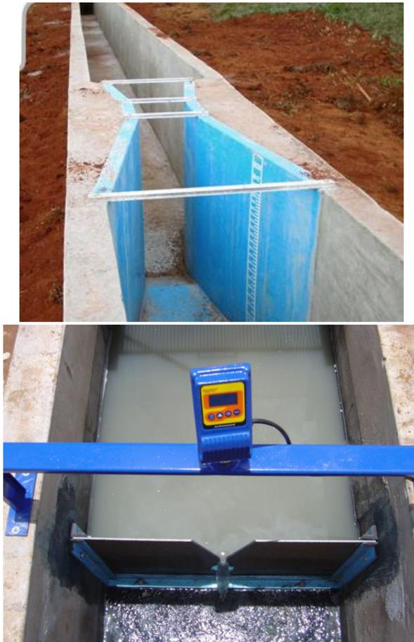
*Figura 19 - Medição por Parshall – manual ou eletrônica*
