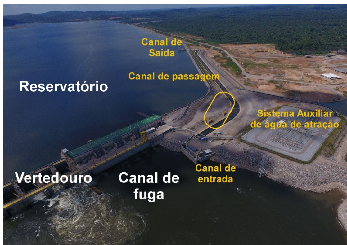
Figura 13.3.6 - 2 – Visão aérea do STP, com indicação das suas partes e das principais estruturas da usina.
