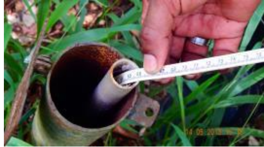
M3 – Leitura profundidade do poço
