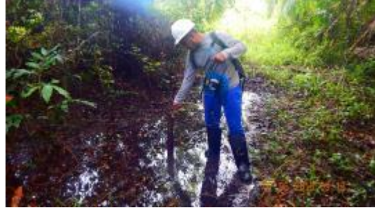
M5 – Leitura profundidade do poço
