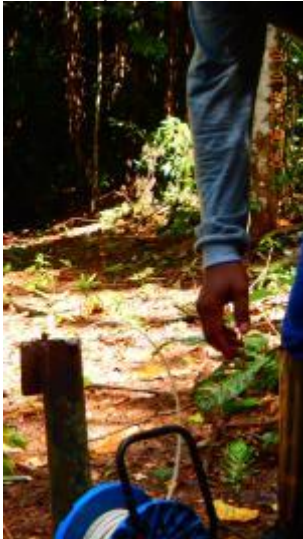
M7 – Medidor Piu e a proteção do poço
