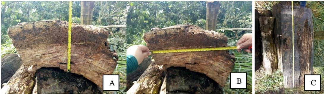
Figura -7. Medições de espessura, largura e comprimento da peça.
