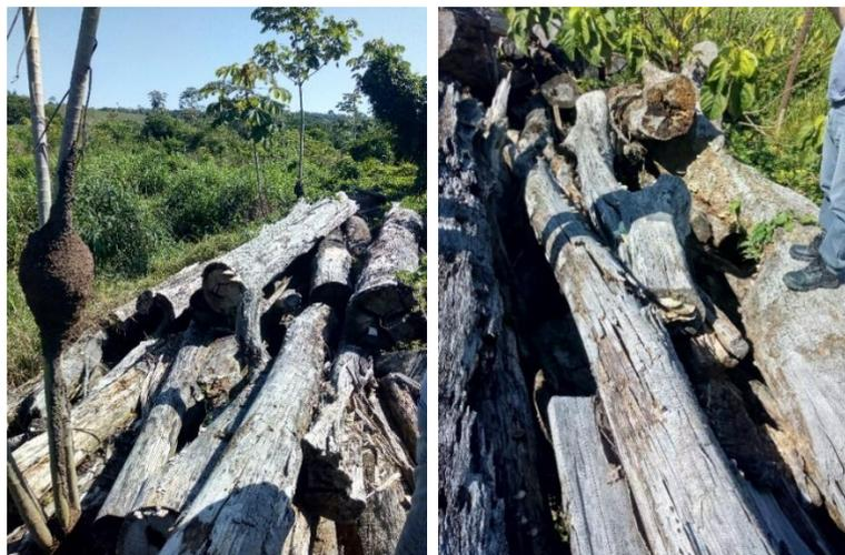
Figura – 3. Degradação da madeira por intempéries – sol, chuva e umidade relativa do ambiente.
