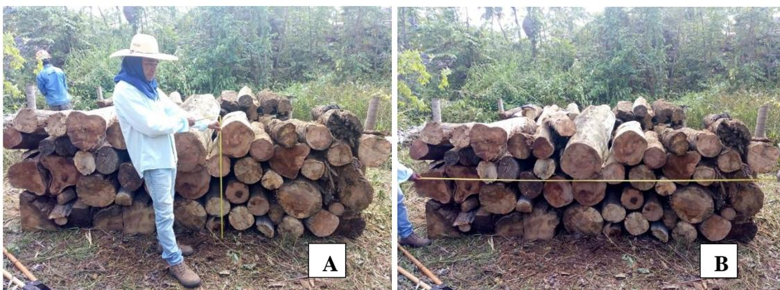
Figura - 6. Determinação de volume estéreo da pilha de madeira.
