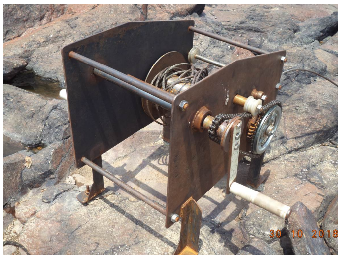
Figura 14.2.4 - 3 – Nova catraca com a inclusão de duas manivelas para dois auxiliares operarem o sistema, no canal da Percata no rio Bacajá.
