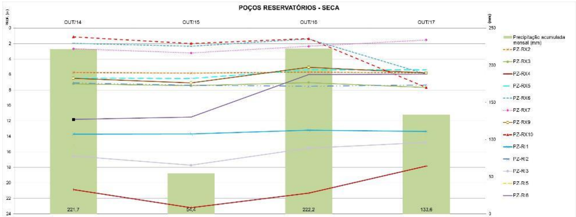
Figura 11.3.1 - 22 – Gráfico mostrando as variações dos níveis (em metros) dos poços instalados para monitoramento, no entorno dos reservatórios Xingu (PZ_RX) e Intermediário (PZ_RI) e precipitação acumulada (mm) nos dois meses anteriores à leitura de nível - SECA. Obs.: Para os poços secos, foi colocado no gráfico o valor de sua profundidade e o símbolo foi pintado de preto (PZ_RI6 seco em outubro de 2014), Nesses casos o nível freático é mais profundo do que a profundidade do poço seco.
