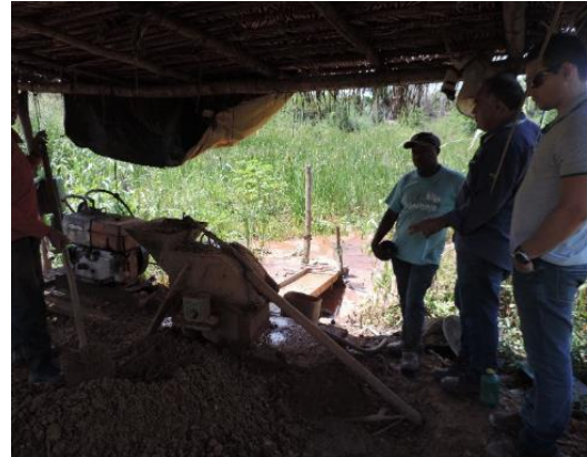
Figura 14.1.1-7 – Moagem rudimentar de rejeitos em um dos pontos de atividade no Garimpo do Galo, em março/2018. Coord. UTM: 397.705E / 9.603.742N.
