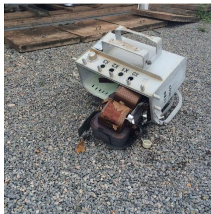
Figura 04: Transformador auxiliar que foi retirado do poste de maneira irregular pelos vândalos.
