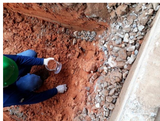
Figura 36: Abertura de cava para investigação de passivos ambientais.
