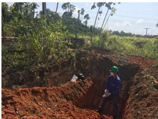
**Figura 27:** Investigação passivos ambientais – coleta de amostra de solo – Posto de combustível – CD – Setembro/17
