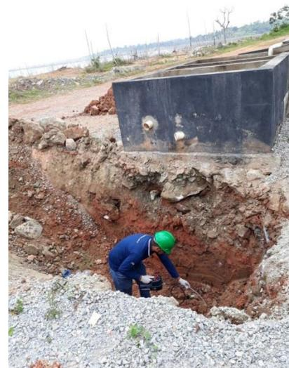
**Figura 18:** Investigação passivos ambientais – Coleta de amostra de solo – Saída Caixa S.A.O Ofic. Central – PI – Setembro/17
