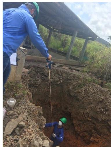
**Figura 28:** Investigação passivos ambientais – Análise dos gases e coleta de amostra de solo – Caixa S.A.O Oficina Mecânica e rampa de lavagem – CD – Setembro/17
