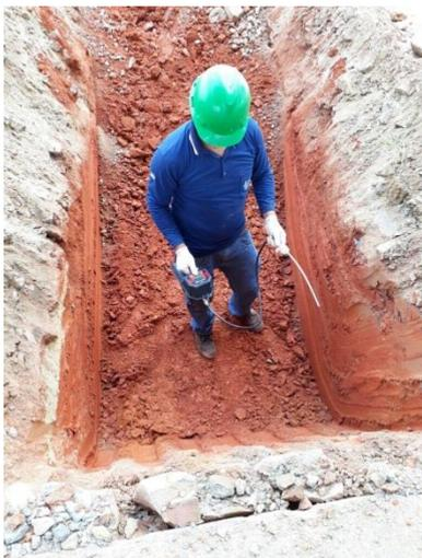
**Figura 21:** Investigação passivos ambientais – Análise dos gases no solo – Posto de combustível – PI – Setembro/17
