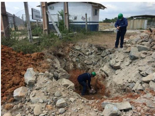
**Figura 19:** Investigação passivos ambientais – Coleta de amostra de solo – Subestação Central de Concreto – PI – Setembro/17
