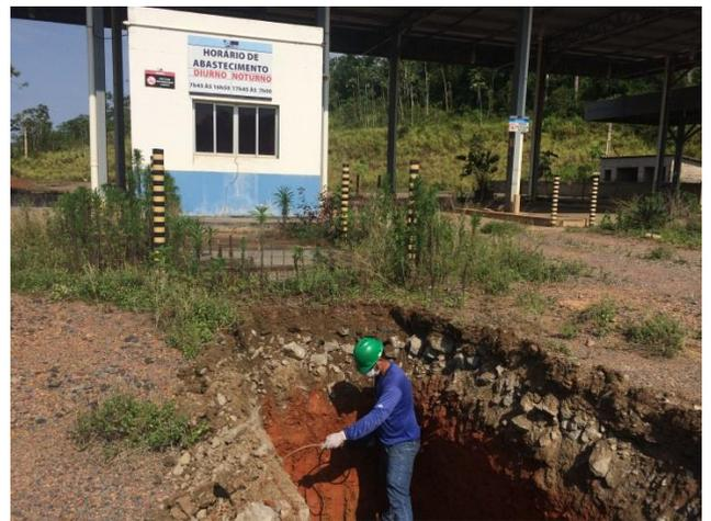
**Figura 16:** Investigação passivos ambientais – Coleta de amostra de solo – Posto Abastecimento – CD – Setembro/17
