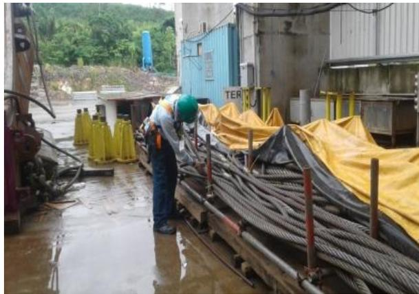
Figura 09: Inspeção da cor do mês em materiais de içamento.
