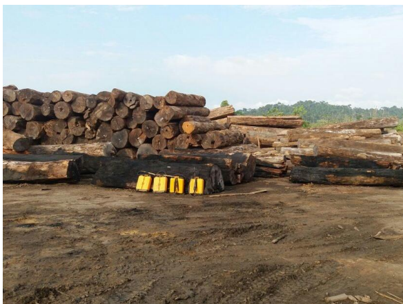
Figura 5.2-17 – Toras com danos parciais, retiradas da pilha e espalhadas, com uso de carregadeira de pneus
