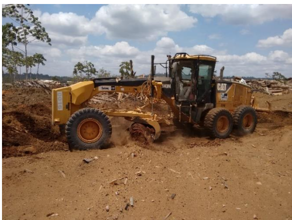
Figura 5.2-3 – Motoniveladora retirando material na tentativa de abertura de aceiro (combate indireto) – frente de fogo - oeste (12h08min)
