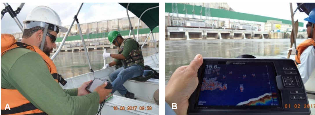
Figura 13.3.2 – 10 – Utilização de sonar a jusante do Sítio Belo Monte. A: Varredura com o sonar; B: Visor com o registro de peixes na área da varredura.
