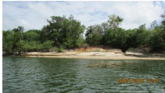
Inspeção trimestral 17 (janeiro/2016 - enchente): Talude e zona de praia ainda expostos devido ao baixo nível do rio. Processo erosivo ativo na continuação do canal a montante do rio devido ao escoamento superficial da microbacia de montante, que, durante os períodos de chuva, carrega sedimentos para o rio.
