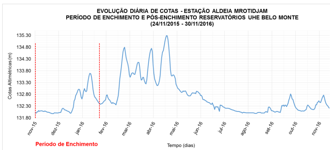
Figura 11.1.2 - 7 – Evolução diária de cotas - Período (2) Enchimento e Pós-enchimento Reservatórios UHE Belo Monte - Estação Mrotidjã.
