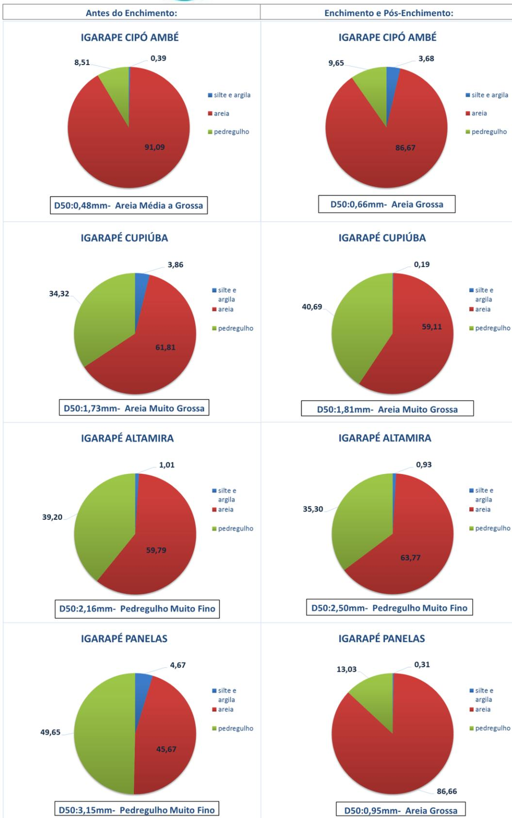
**Figura 11.1.1 - 11 – Comparação (%) do Material do Leito dos Igarapés de Altamira.**
