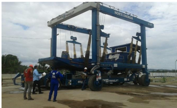
Figura 17 - Transposição de embarcação de grande porte pelo elevador de pórtico móvel
