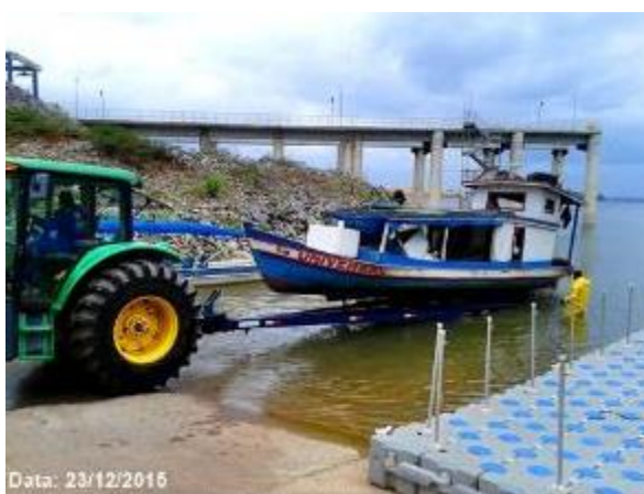
Figura 18 - Transposição de embarcação de grande porte, sentido jusante para montante
