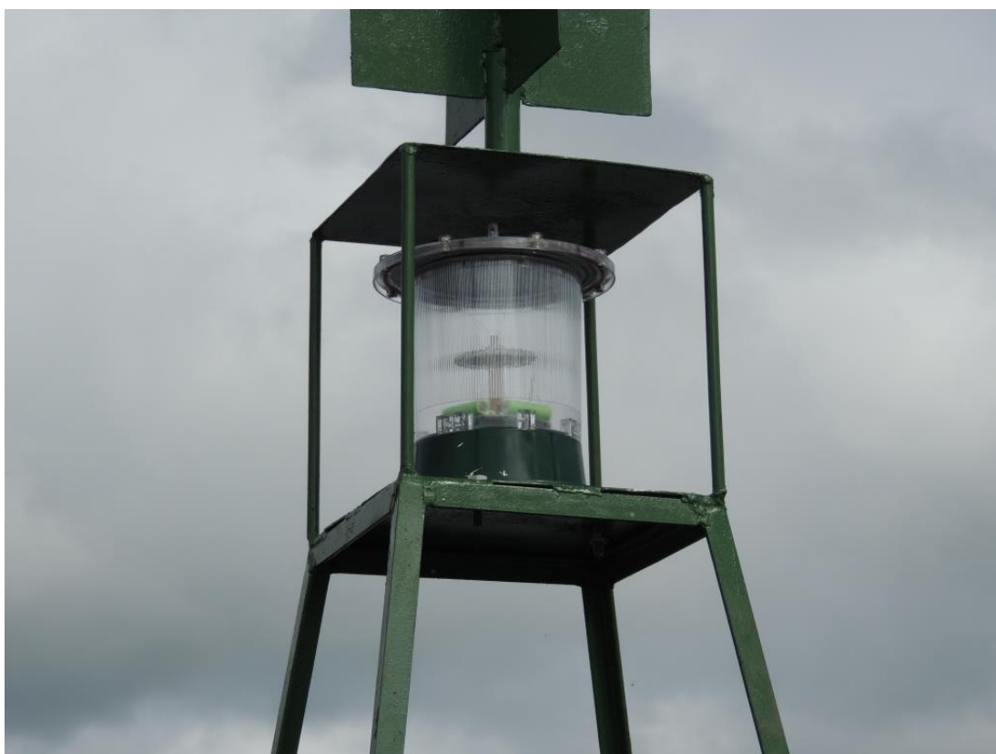
Figura 14.2.4 - 3 - Detalhe do sistema de sinalização noturna (lâmpada) da boia da figura anterior.
