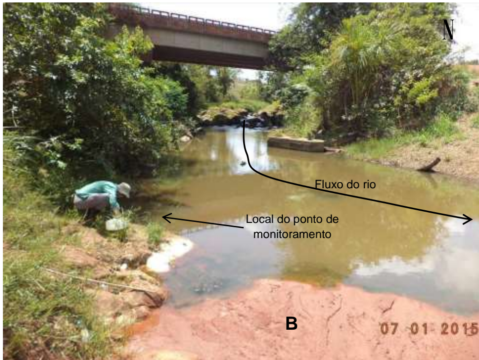
Foto - 3 – Detalhe do ponto de monitoramento (PACBM-J) onde podemos observar próximo a margem direita o início de assoreamento (B).
