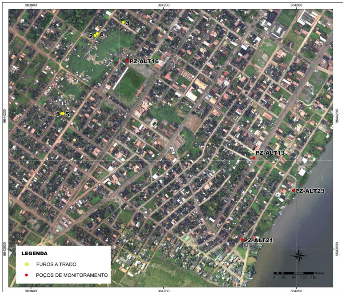
Figura 11.3.1 - 3 – Localização dos Poços de Monitoramento na região do bairro Jardim Independente I até o rio Xingu e dos furos a trado realizados em junho/2016
