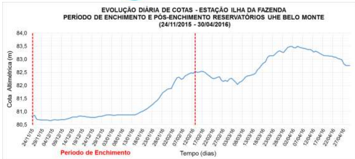
Figura 11.1.2 - 28 – Evolução diária de cotas Rio Xingu - Período (2) Enchimento e Pós-enchimento Reservatórios UHE Belo Monte - Estação Ilha da Fazenda.
