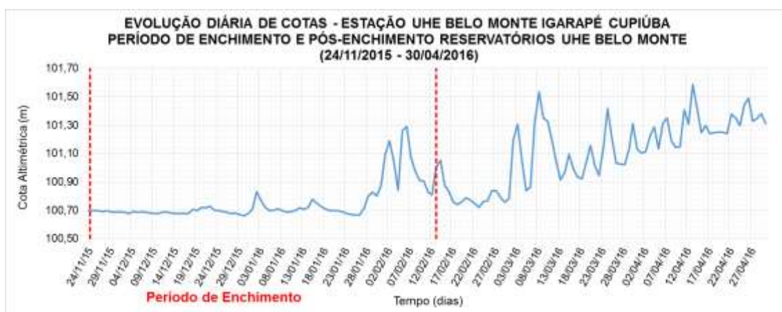
Figura 11.1.2 - 50 – Evolução diária de cotas - Período (2) Enchimento e Pós-enchimento Reservatórios UHE Belo Monte - Estação UHE Belo Monte Igarapé Cupiúba.
