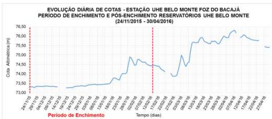
Figura 11.1.2 - 13 – Evolução diária de cotas - Período (2) Enchimento e Pós-enchimento Reservatórios UHE Belo Monte - Estação UHE Belo Monte Foz do Bacajá.
