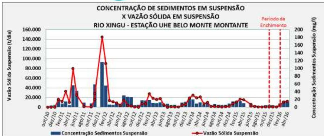
Figura 11.1.1 - 16 – Concentração de Sedimentos x Vazão Sólida de Sedimentos em Suspensão - Período de outubro/2010 a abril/2016 - Rio Xingu - UHE Belo Monte Montante.
