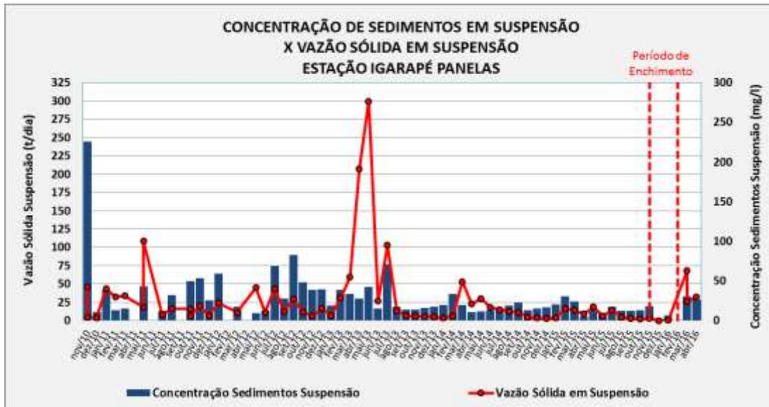
Figura 11.1.1 - 31 – Concentração x Vazão Sólida de Sedimentos em Suspensão - Campanhas mensais de medição - Período de novembro/2010 a abril/2016 - Estação UHE Belo Monte Igarapé Panelas.
