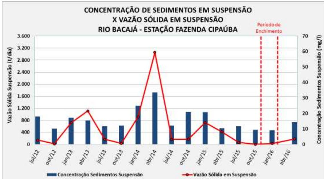
**Figura 11.1.1 - 36 – Concentração x Vazão Sólida de Sedimentos em Suspensão - Campanhas mensais de medição - Período de julho/2012 a janeiro/2016 - Rio Bacajá - Estação Fazenda Cipaúba.**
