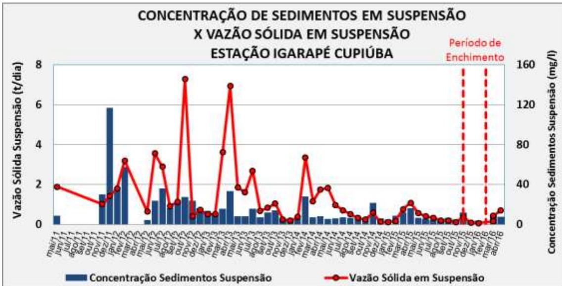
Figura 11.1.1 - 27 – Concentração x Vazão Sólida de Sedimentos em Suspensão - Campanhas mensais de medição - Período de março/2011 a abril/2016 - Estação UHE Belo Monte Igarapé Cupiúba.
