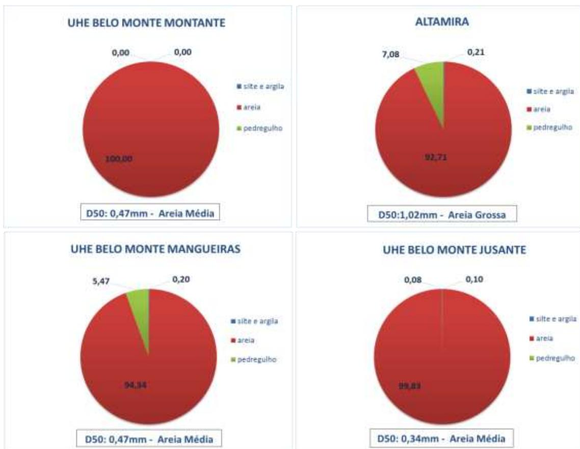
**Figura 11.1.1 - 6 – Comparação da composição granulométrica (%) das estações do rio Xingu: UHE Belo Monte Montante, Altamira, UHE Belo Monte Mangueiras, UHE Belo Monte Jusante a partir dos dados de monitoramento.**
