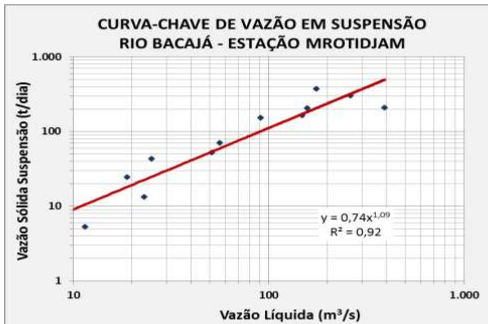
Figura 11.1.1 - 39 – Curva-Chave de Sedimentos em Suspensão - Período de novembro/2012 a novembro/2015 - Rio Bacajá - Estação Mrotidjã.
