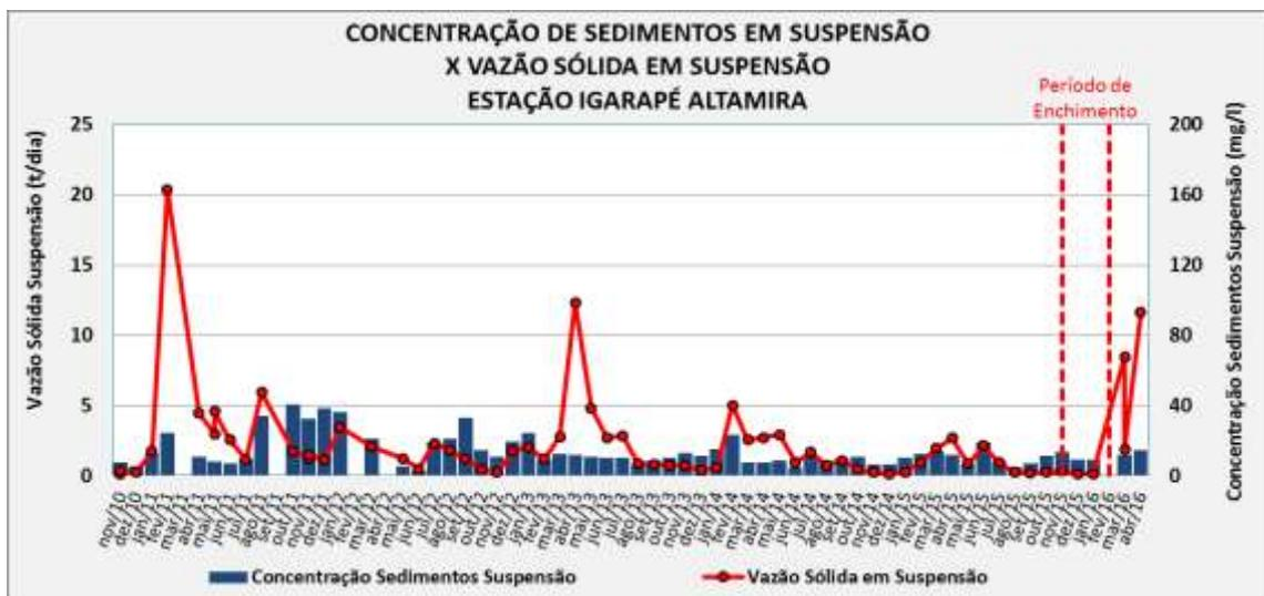
**Figura 11.1.1 - 29 – Concentração x Vazão Sólida de Sedimentos em Suspensão - Campanhas mensais de medição - Período de novembro/2010 a abril/2016 - Estação UHE Belo Monte Igarapé Altamira.**
