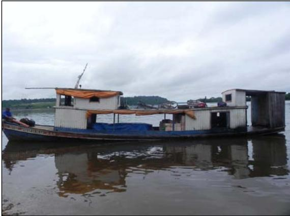
**FIGURA 3-6** - Barco de Madeira com capacidade de carga entre 4,0 e 07 toneladas
