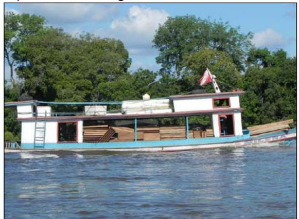
**FIGURA 3-9** - Barco de Madeira com capacidade de carga entre 4,0 e 07 toneladas
