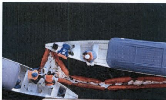
Figura 8 – Mitigação com mantas e cordões absorventes
