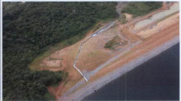
**Foto 12** – Dispositivo que mantém vazão para jusante em dique do reservatório Intermediário.
