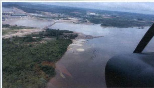
**Foto 17** – Praia artificial sendo implantada a montante do Canal de Fuga com areia oriunda da dragagem obrigatória do Canal.
