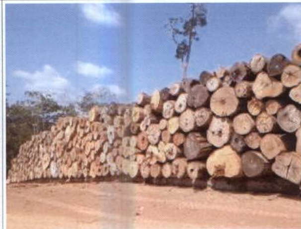
Foto 30: Pátio desorganizado no Lote C onde observou-se perda de madeira por apodrecimento e rachaduras.
