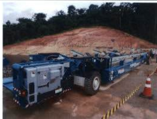
Foto 68 – Transporter – equipamento que tem a função de transportar as grande embarcações de um pier para o outro.
