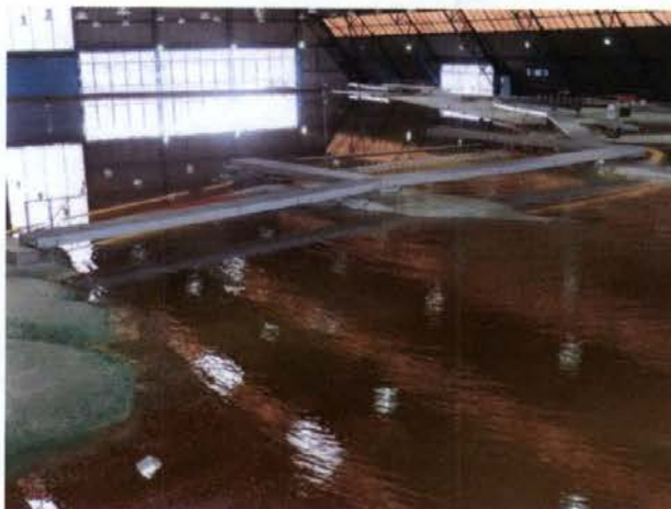
Foto 1 – Modelo Hidráulico reduzido da UHE Belo Monte – conjunto do sítio Pimental.
