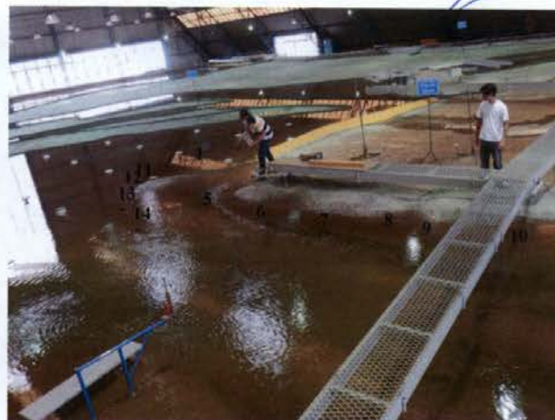
Foto 2 – Ensaio de condições de escoamento no canal as margens da ilha da Serra.
