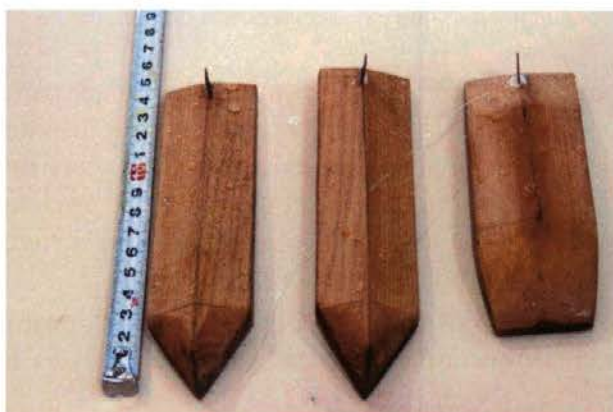
Foto 3 – Embarcações de madeira utilizadas nos ensaios do modelo hidráulico reduzido.
