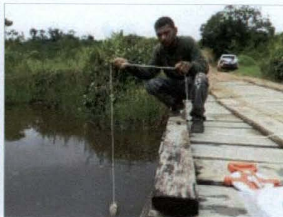
Foto 36. Medição da profundidade média dos trechos amostrados, com auxílio de corda milimetrada com peso na extremidade.
