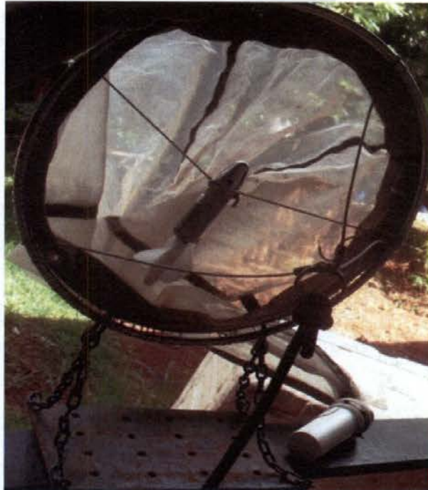
Figura 3.5 - 1 – Rede de ictioplâncton e seus acessórios (fluxômetro, deflador e copo coletor)
