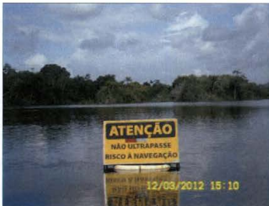
Figuras 11 e 12 - Sinalização a montante do acesso à ilha Pimental com aplicação de adesivo refletivo para visualização noturna.
