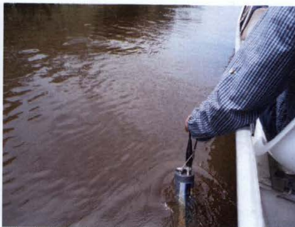
Foto 8 – Sonda multiparamétrica coletando dados da qualidade da água próximo ao ponto de captação de água da aldeia da TI Arara da Volta Grande.
