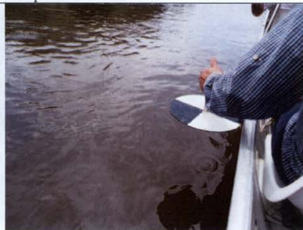
Foto 46 – Disco de Secchi sendo introduzido no rio Xingu para medição da transparência próximo ao ponto de captação de água da aldeia da TI Arara da Volta Grande.
