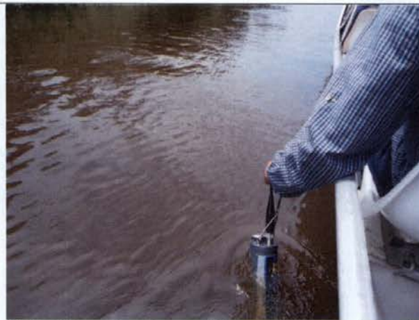
Foto 45 – Sonda multiparamétrica coletando dados da qualidade da água próximo ao ponto de captação de água da aldeia da TI Arara da Volta Grande.
