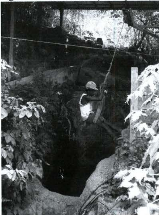
Figura 38. Empregado do Garimpo do Galo descendo no túnel formado pela extração do quartzo que contém o ouro, mostrando as precárias condições de trabalho. Coordenadas: UTM 22, 397.493 E e 9.603.590 N.
