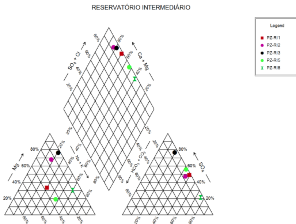
Figura 11.3.2 - 11 – Diagrama de Piper de poços de monitoramento no entorno do futuro Reservatório Intermediário (coleta trimestral 7 - janeiro/2014).
