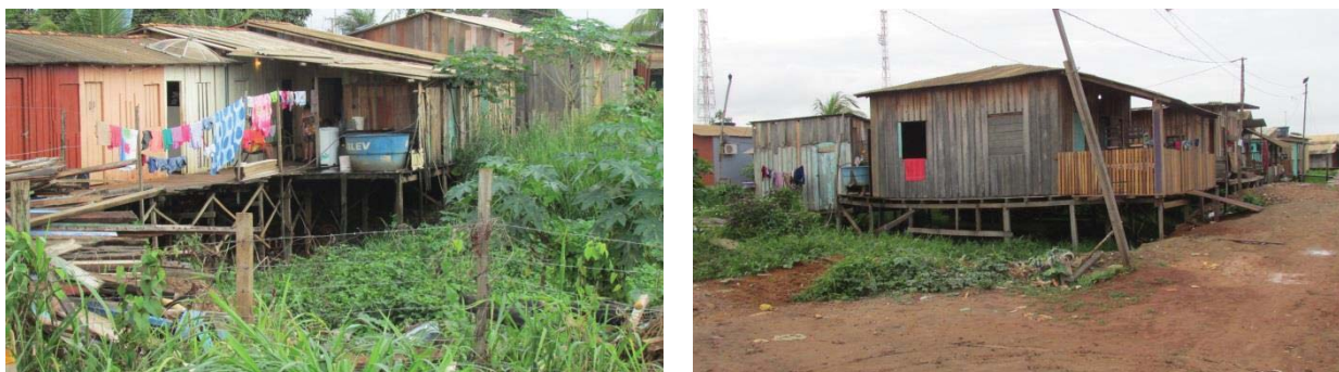
Figura 5 - Exemplos de edificações na forma de palafitas, que são implantadas para minimizar a necessidade de aterros em área que sofre inundações periódicas naturais (pelo escoamento superficial e pela elevação da superfície freática).
