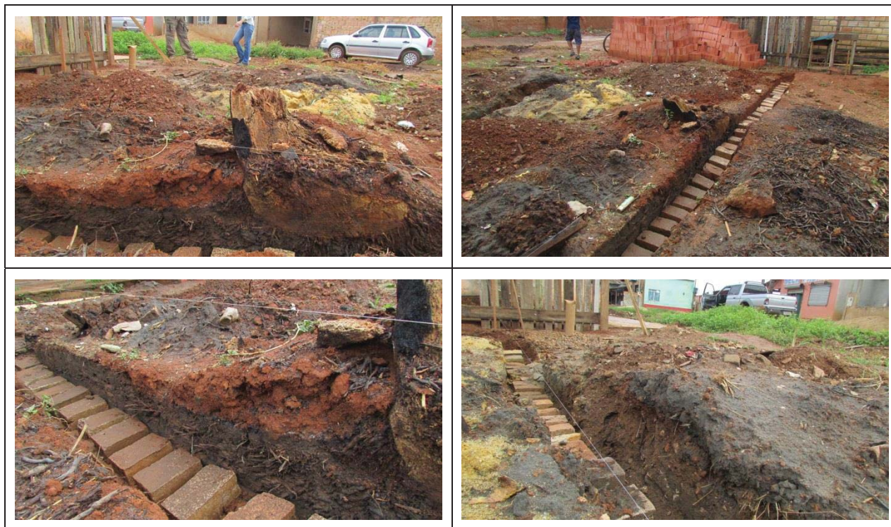
Figura 8 – Aspectos dos gleissolos observados em uma das áreas de ocupação em estudo. A cor cinza, enriquecimento em matéria orgânica, textura muito argilosa e perfil típico são as propriedades físicas que caracterizam estes solos.
