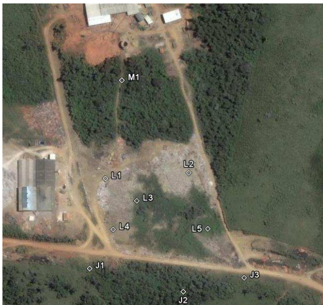
FIGURA 6-16 - Localização das Sondagens Executadas para Caracterizar o Lixão da Cidade de Altamira
