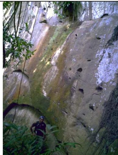
*Foto 6.4 – Detalhe de outro paredão com condicionamento estrutural. Destacam-se as inúmeras feições de pipping.*
