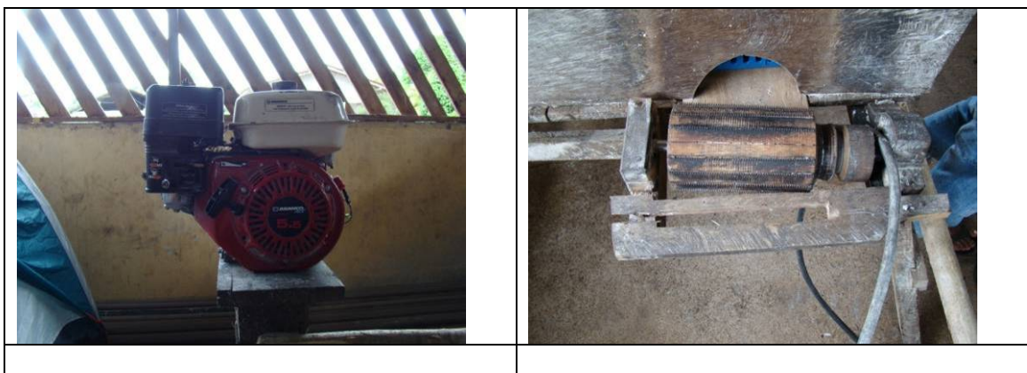
FIGURA 4.6.8-6 -Motor que Traciona o Cilindro b) Bola Catitu /Cilindro Provido de Eixo Central com Serrinhas
