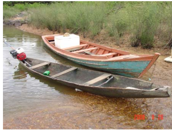
Tipos de cascos rabeta, que utilizam motor de popa a gasolina e/ou gás.
