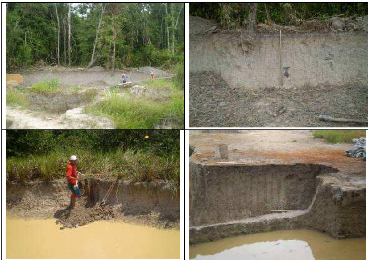
**Fotoimagem 9.** Aspecto geral da camada de argila que ocorre na planície aluvionar do Igarapé Panelas – Área Sindoalta.
