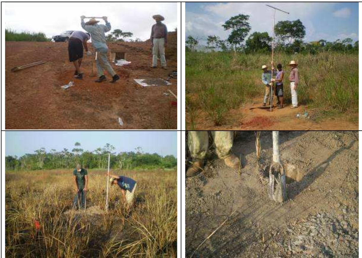
**Fotoimagem 11.** Detalhes da sondagem a trado tipo concha de 4 polegadas.
