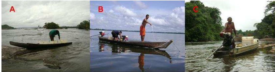
FIGURA 7.8.4.1- 61 - Embarcações utilizadas na captura de peixes ornamentais ao longo da calha dos rios Xingu e Iriri: (A) canoa movida a remo, (B) “rabeta” com casco de madeira, (C) “rabeta” com casco em alumínio (Fotografias: Priscila Carmona).
