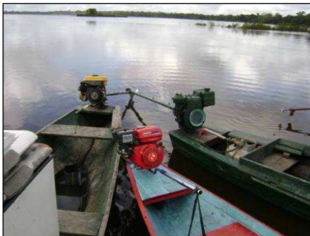
FIGURA 7.8.4.1- 41 - Detalhe do motor rabeta de canoas de pesca do rio Xingu (Fotografia: Roberto E. Santo).
