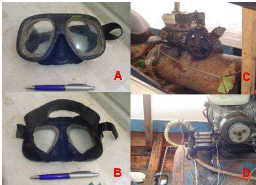
FIGURA 7.8.4.1- 62 - Estado de uso de alguns materiais utilizados nas pescarias de peixes ornamentais na região do Arroz Cru – Altamira – PA – A e B: frente e verso de mascareta; C e D: compressor enferrujado em com vazamento nas saídas de ar (Fotografias: Jaime Carvalho Júnior).
